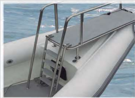
PLATAFORMA DE PROA C/ESCALERA INTERIOR
